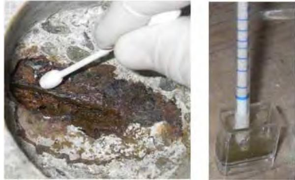
PC鋼材腐食の原因が塩化物
