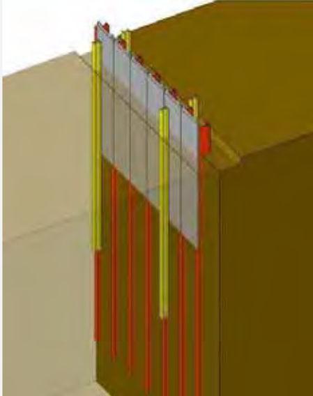
Step5 導枠撤去
