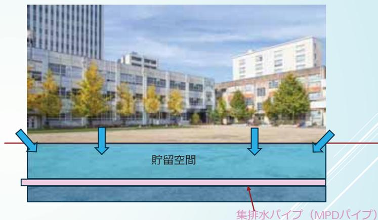
公共の運動場等の地下に**集排水パイプ**を推進工法により布設し、
