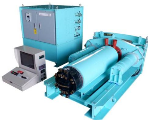
写真-1 リターン型掘進機
