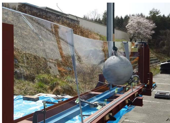
300kg突起付き鉄球を衝突させたときの状態 (※想定外の荷重に対する確認実験)
