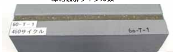
タフネスコート被覆試験体
