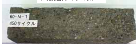
AEコンクリート試験体
