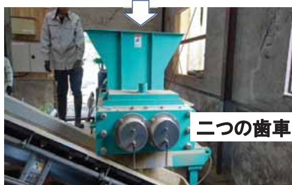
2軸臼植栽機 生竹をすり潰す機械
