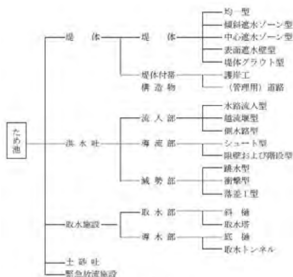
図-1.4.1 ため池の施設構成
