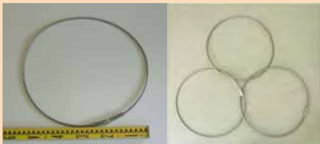
ワイヤーリング (φ8mm : リング径350mm, 600mm, 800mm)
