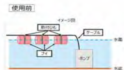
フイにケーブルを取り付ける
