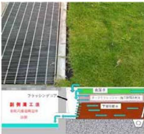
こちらの施設では排水対策として透水管パイプを埋設しておりましたが、約3年で詰まりが発生し、著しく排水機能が低下し、芝の品質が低下したため、副側溝工法により排水の改善、対応いたしました。床土は全て高草の敷き替えを行いました。
