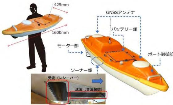
図 1. マルチビーム一体型深浅測量用無人リモコンボート「RC-M1」
