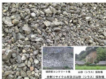
破砕前コンクリート塊 山砂(シラス)採取場 余剰リサイクル材及び山砂(シラス)採取場
