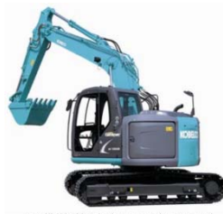
iNDr搭載極低騒音型バックホウ(SK135SR-2)
