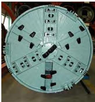
写真-2 硬質土対応型ヘッド
