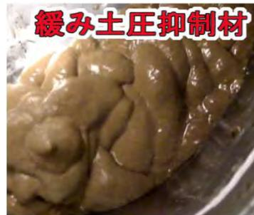
写真-6 緩み土圧抑制材
