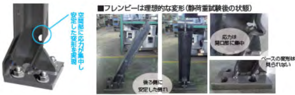
■フレンビーは理想的な変形(静荷重試験後の状態)
