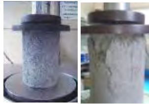
一軸圧縮強度試験 1.2MPa以上
