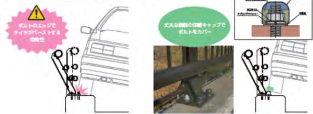
■前側アンカーに懸念されるタイヤバースト対策
