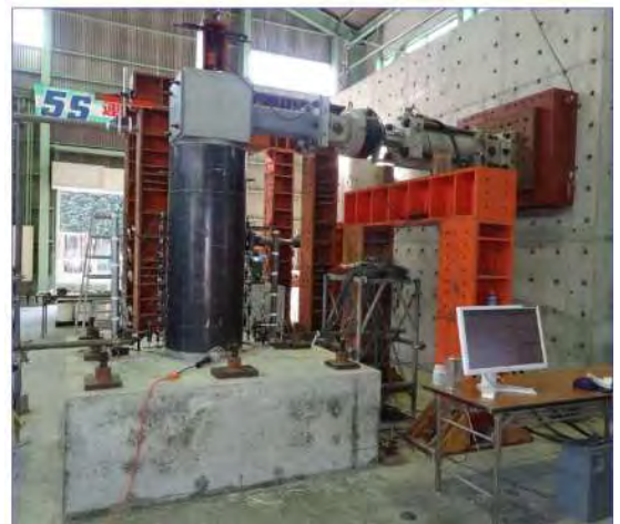
写真-1 正負交番載荷試験（円形）状況
