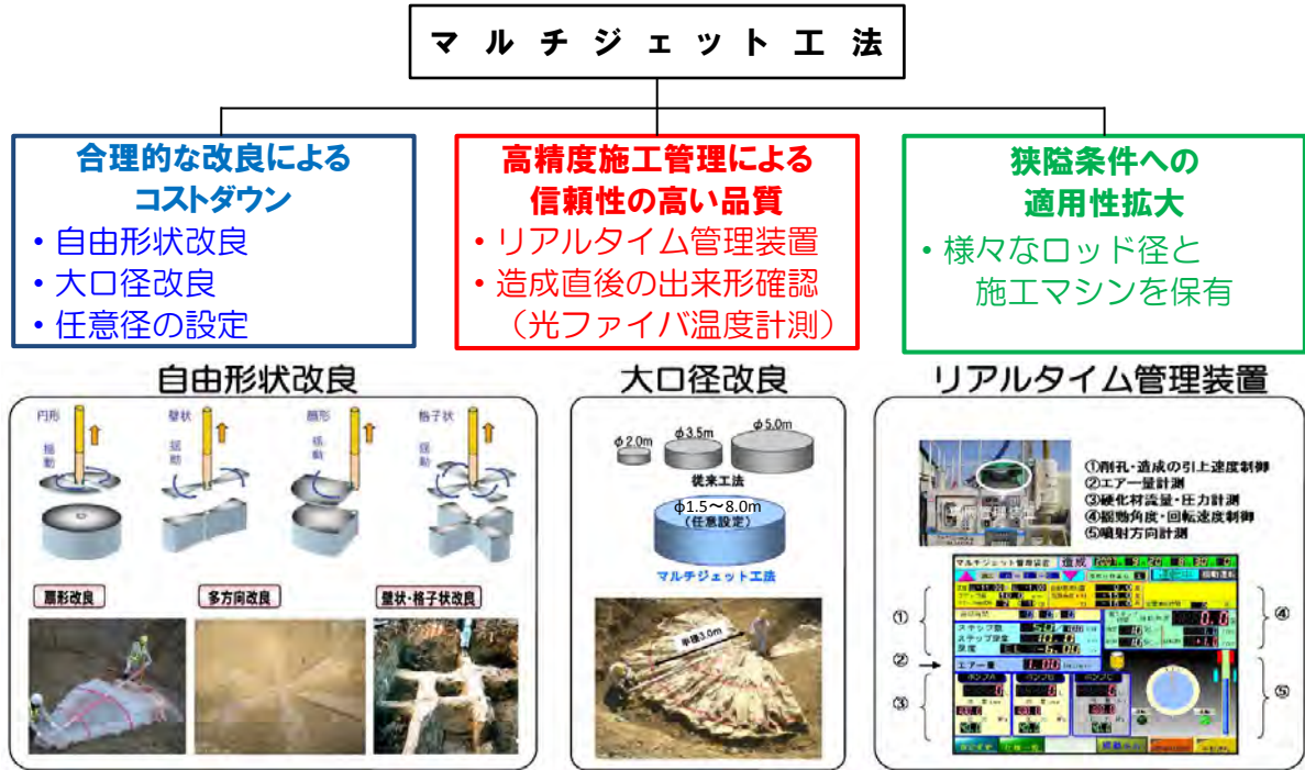
図-1 マルチジェット工法の3つの特徴
