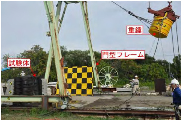
重錘落下実験状況
