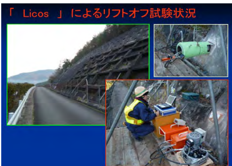
図-3、写真-3 Licosによるリフトオフ試験状況
