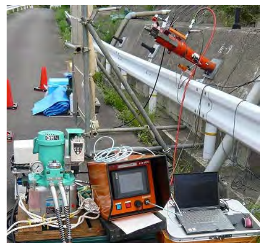
図-3、写真-3 Licosによるリフトオフ試験状況
