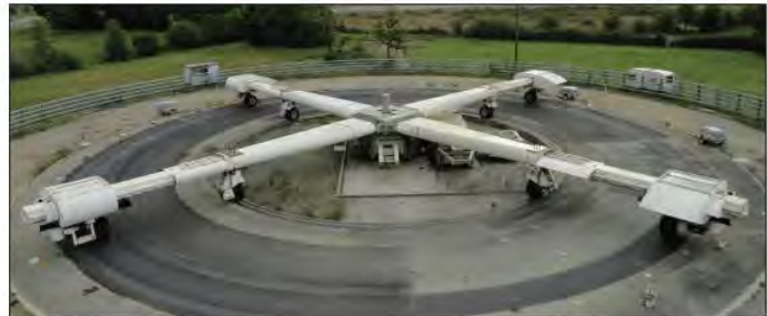
輪荷重走行試験 (フランス)
