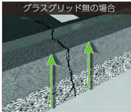
リフレクションクラック発生
