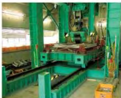
輪荷重走行疲労実験(日本大学生産工学部にて)
