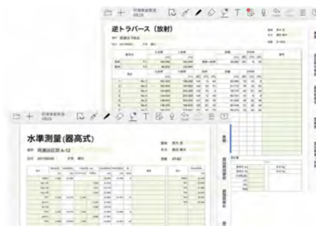
図-6 自動計算可能な土木向けテンプレートを搭
