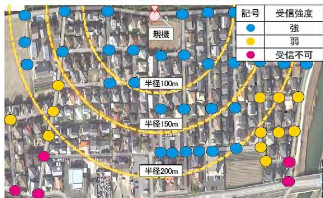
図-3 住宅地における通信能力の検証試験結果
