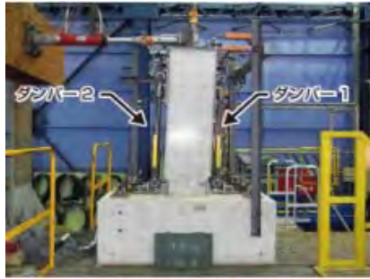
ダンパーを設置した橋脚の実験状況
