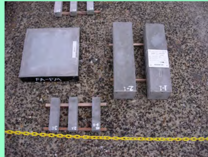
35ヶ月後の付着試験用平板、 4 \times 4 \times 16 、 10 \times 10 \times 40 試験
