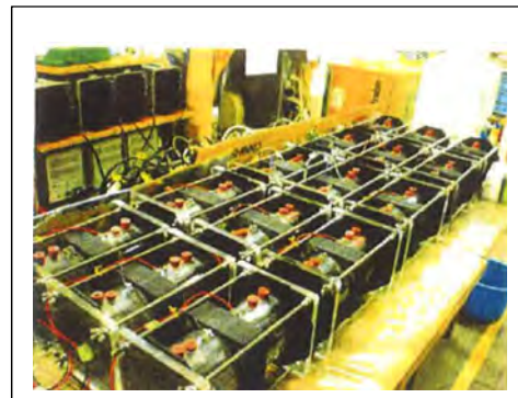
図6 遮塩性能試験状況
