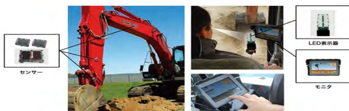
2Dマシンガイダンスシステム「iDig」の概要
