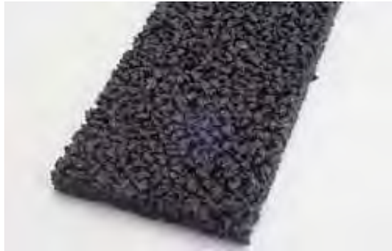
ゴムチップフィルター設置1年経過状況
