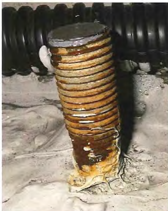
ボルト全周が均一に減肉している時 (ボルトM24)
