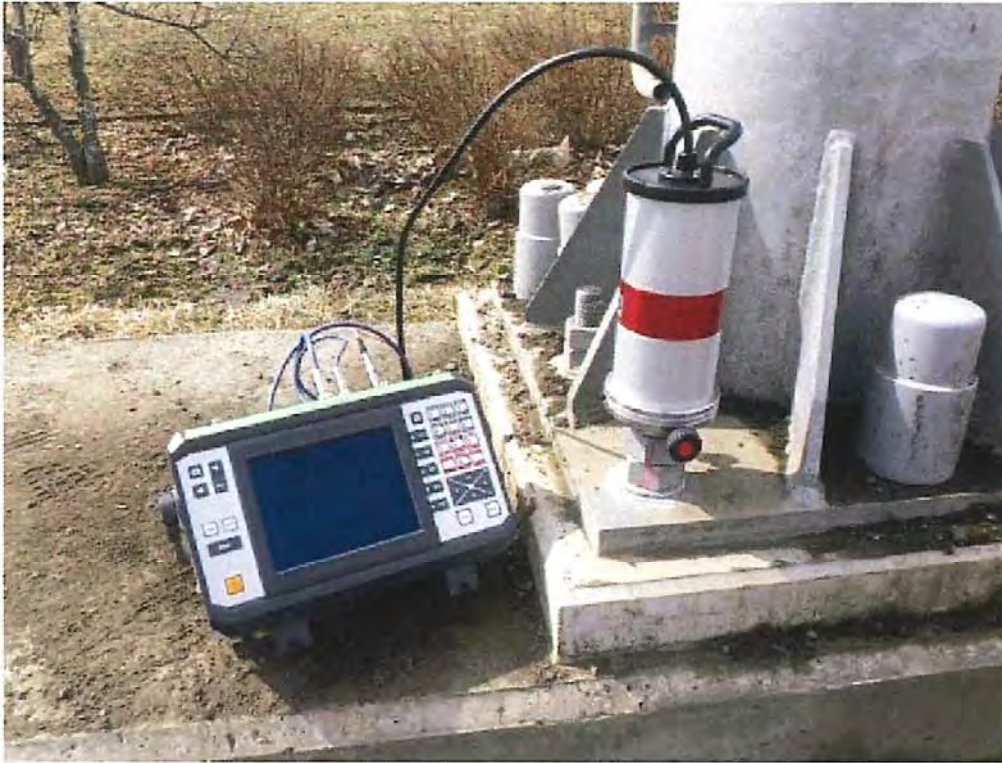
(a) 超音波探傷器および欠損点検治具
