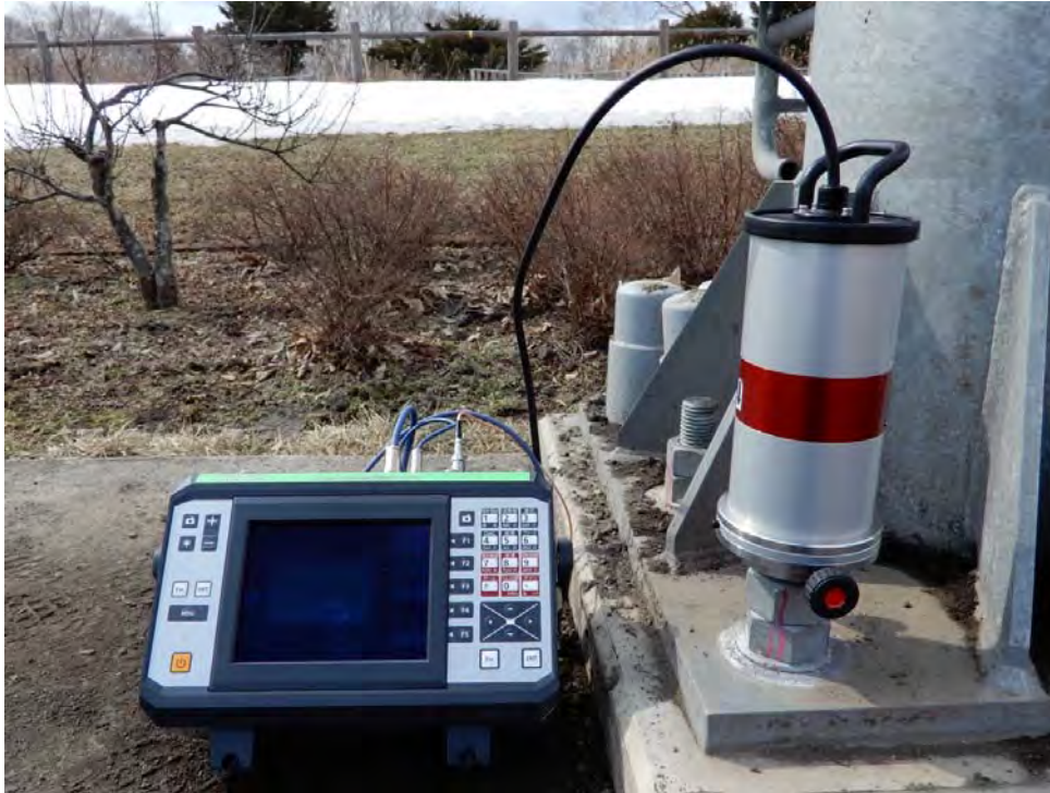
SABHCのボルトへの設置状況 〈欠損点検システム〉
