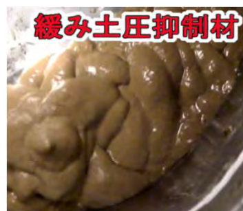
写真-6 緩み土圧抑制材
