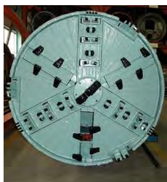
写真-2 硬質土対応型ヘッド
