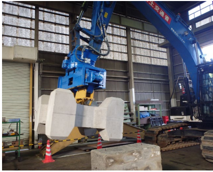
大型ブロック等をつかむ 重機用アタッチメントの開発
