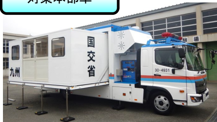
車両を拡幅し現地での対策拠点
