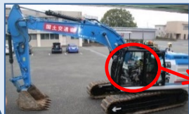
【簡易遠隔操縦装置】 ロボQS
