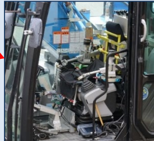
【簡易遠隔操縦装置】 ロボQS
