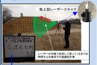
点群データと写真画像を統合(自動処理)
