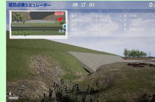
例1) VRで再現した堤防・護岸の変状を点検
