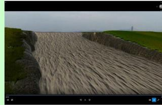
例3) 越流破堤を体験、発生メカニズムの解説
