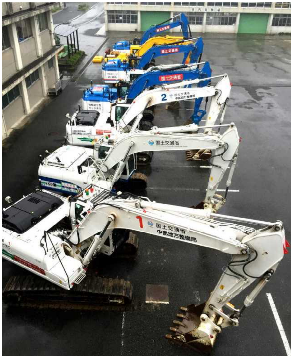
写真：出動指示を待つ無人化施工機械 国土交通省九州技術事務所（久留米市）にて
