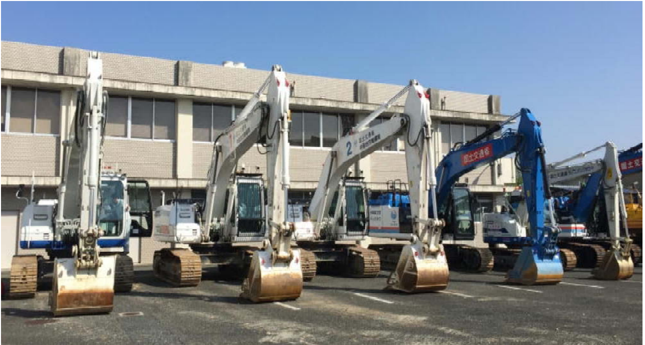
被災地へ向け、20時に出発する無人化施工機械（遠隔操縦式バックホウ） 九州技術事務所（久留米市）にて撮影
