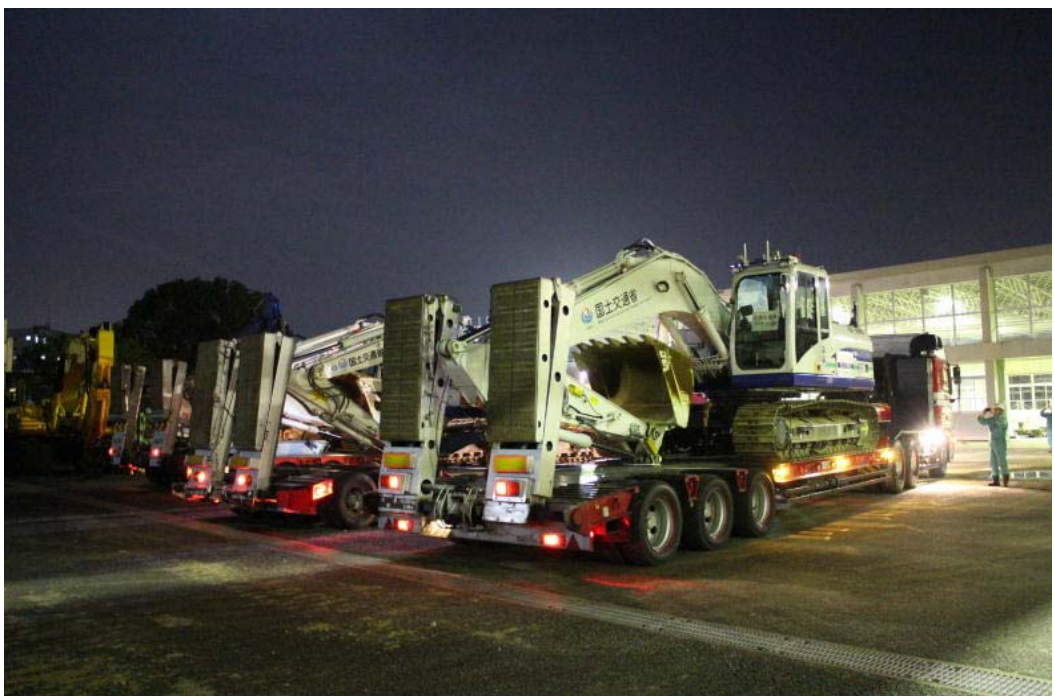
▲ 出発の準備が完了した遠隔操縦バックホウ（4台）
