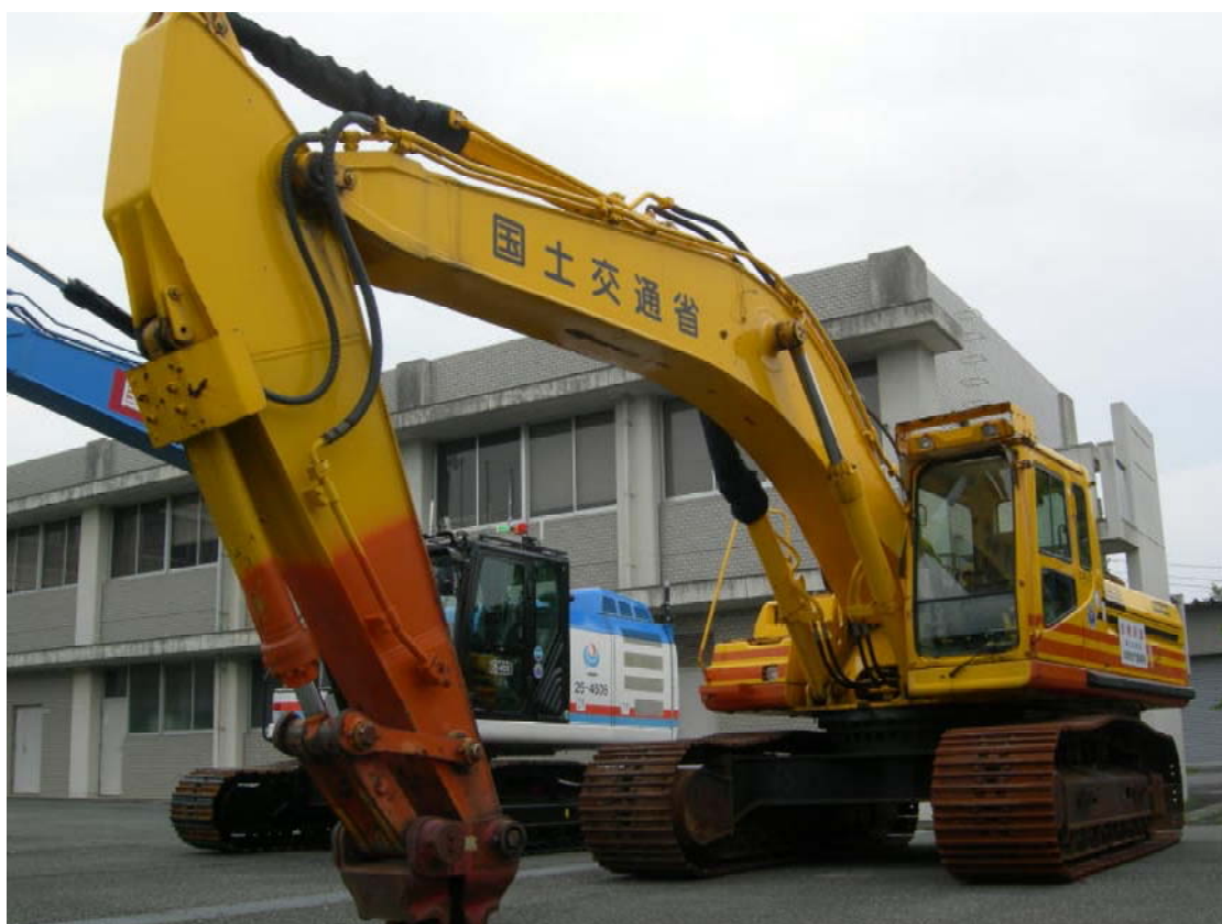
被災地へ向け、14時に出発する無人化施工機械（遠隔操縦式バックホウ） 九州技術事務所（久留米市）にて撮影
