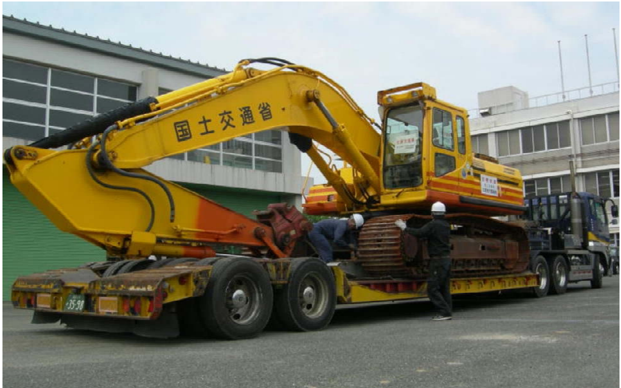
出発の準備をする無人化施工機械（遠隔操縦式バックホウ） 九州技術事務所（久留米市）にて撮影
