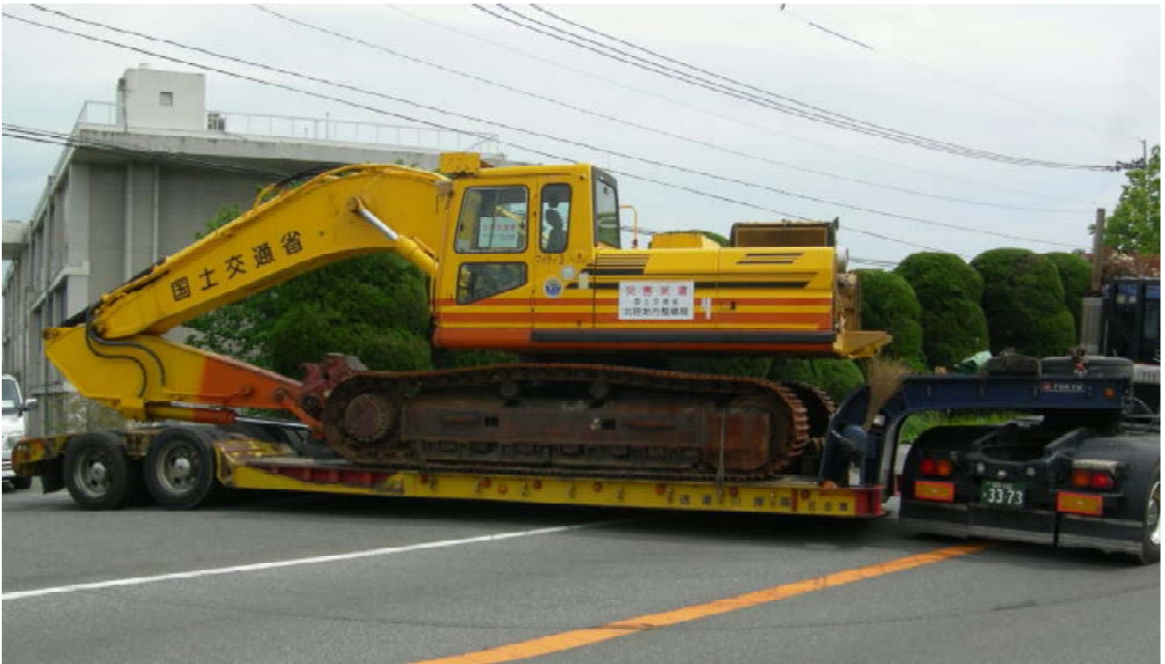
被災地へ向け、14時10分に出発した無人化施工機械（遠隔操縦式バックホウ） 九州技術事務所（久留米市）にて撮影
