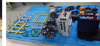
遠隔操縦装置の分解状況
