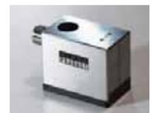
超音波探傷機 Dio-1000LF(SH波回転探査用改造機)仕様
