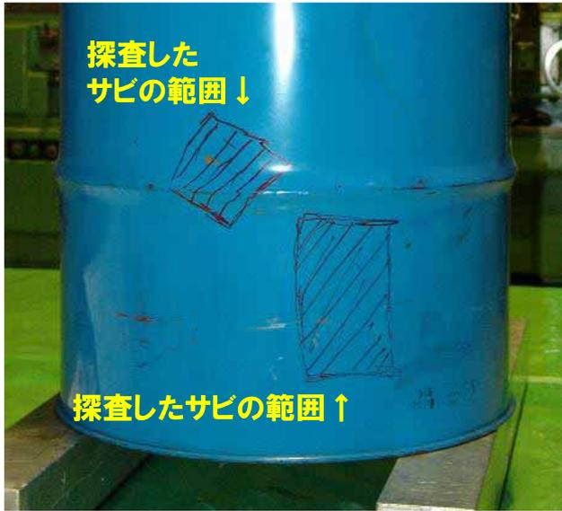
SH波は断面全域を伝搬するため、プレス加工の断面の欠損等でも問題なく検知できる。
