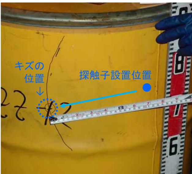
1. 探触子を青い丸の位置に設置し、回転させる。
