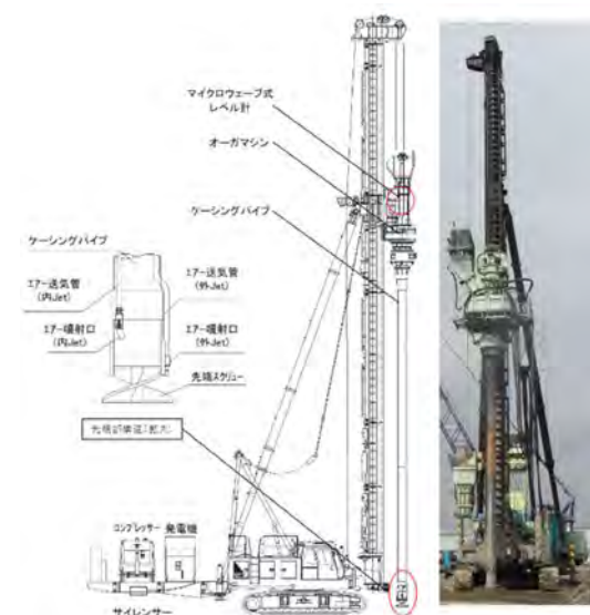
図-1 施工機の概要
