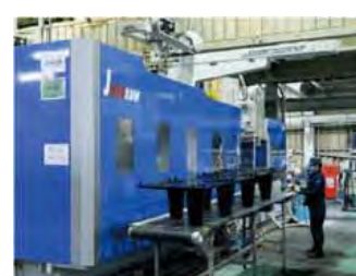
大型成型機によるインジェクション成型
