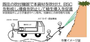
既往の吹付機で本資材を吹付け、BSCを形成し、侵食を防止して植生侵入を促進 ※現場条件により手撒きやヘリ散布、散資材との併用等も可能 ①吹付機、吹付機 ②BSC形成機 ③散資材、散資機 ④BSC形成機 ⑤散資機、散資機 ⑥散資機、散資機 散材投入車 散材投入車 散材投入車 作業イメージ図
