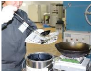
■マーシャル試験供試体作成(1) 高温でドロドロになったアスファルトを計量します。
