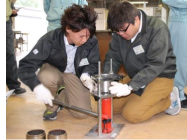
■マーシャル試験供試体作成(3) モールドに入れて突き固めた供試体を抜き取ります。ジャッキでキコキコ
