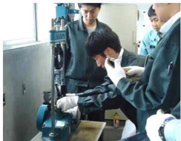
■マーシャル安定度試験(1) 試験機で供試体に荷重をかけます。最大荷重時の変形量を読みます。
