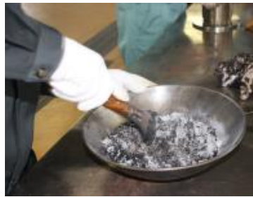
■マーシャル試験供試体作成(2) 110°Cで乾燥させた骨材とアスファルトを練り混ぜます。温度が重要!熱々です(汗)
