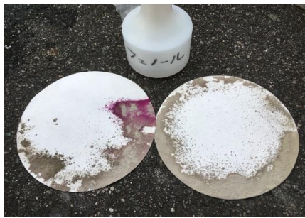
【実習・中性化深さ試験③】 ドリルによる削りくずが赤紫色に変色しました。 アルカリ反応が出たところで削孔をストップ！
