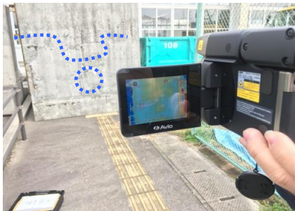
【空洞探査デモ】 サーモグラフィを使ってコンクリート中の 空洞を探すデモをやりました。 空洞部分の色が違うのがわかりますか？
