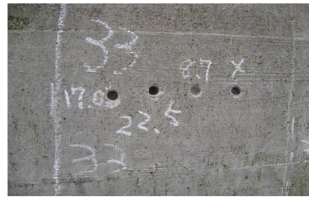
【実習・中性化深さ試験④】 ドリルの刃を抜き取り、孔の深さを測ります。 これで中性化の深さの測定ができました！
