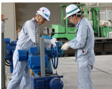
■ 小型水門の操作実習(初日) ゲートが下降しないときは 手動で優しく...
