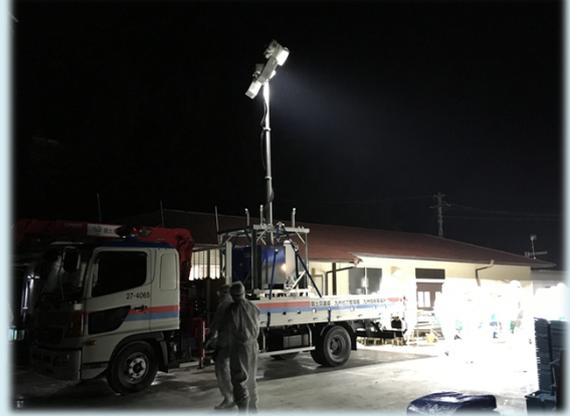
作業車に載せた簡易照明装置
