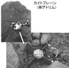
九州大学などが雲仙普賢岳へ投下したペネトレータ
