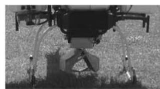
北海道開発局が開発した試料採取装置搭載の自律航行型無人ヘリ
