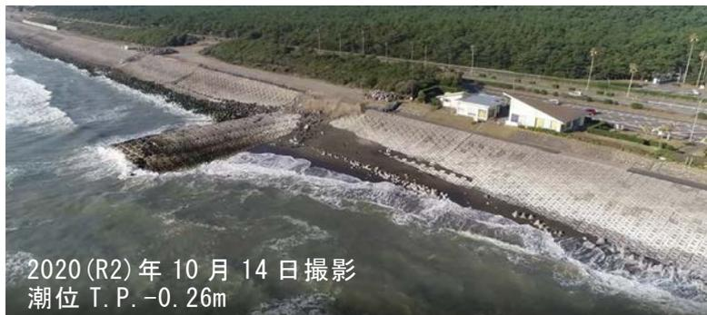
写真ー 3.3 2020(R2)年川砂利・川砂養浜投入後の補助突堤①周辺の様子
