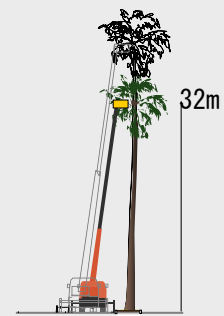
高所作業車の作業限界高 (1車線規制で32m)
