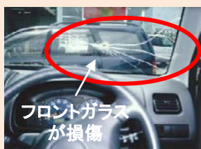
フロントガラスが損傷 枯れ枝の落下による 通行車両への損傷の例
