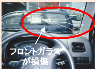
枯れ枝の落下による 通行車両への損傷の例
