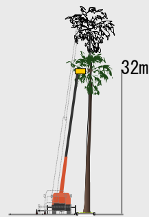
高所作業車の作業限界高 (1車線規制で32m)
