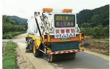
道路上に溜まった土砂などを除去します。又新燃岳噴火による降灰時も清掃します。
