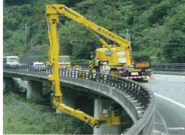
地震等発生時の点検を行い、橋梁の異常や損傷等の有無を確認します。
