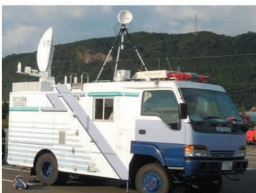
通信衛星システムを利用し、災害現場の映像などの情報を伝送します。
