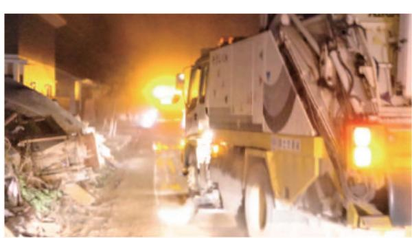
▲災害対策車(路面清掃車)による清掃作業
