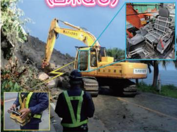
2次災害の恐れがある危険な現場でバックホウを遠隔操作します。
