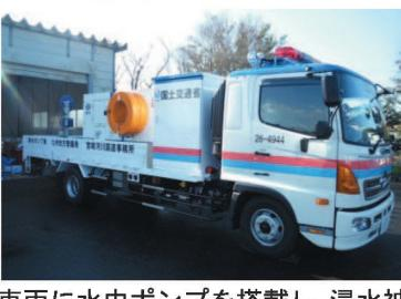
車両に水中ポンプを搭載し、浸水被害が発生した箇所での排水運転を行います。
