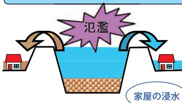
土砂堆積による河床上昇・洪水氾濫
