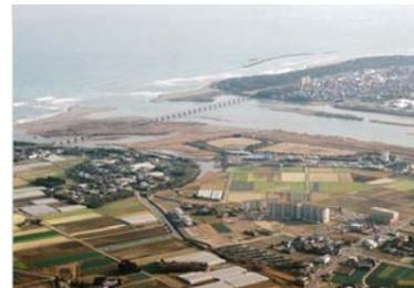
a) 堆砂による閉塞が著しい航路
