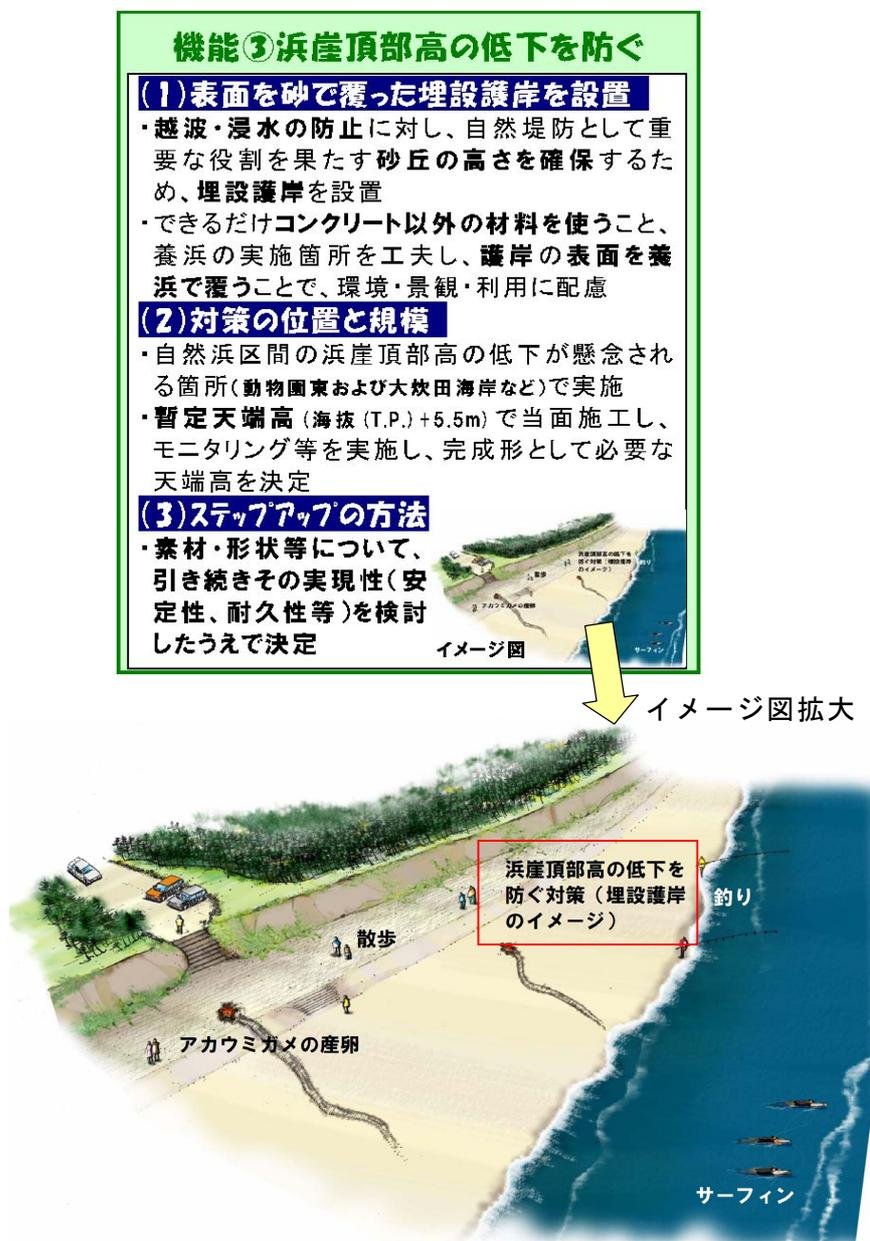
図－1 機能③：浜崖頂部高の低下を防ぐ対策の概要
