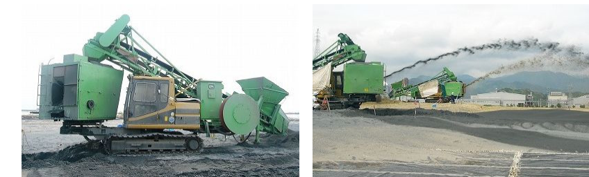
図－ 2.20 シューティングマシンによる土砂の散布イメージ
