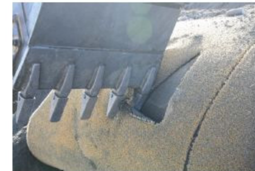
写真 I-4.4.1 掘削機バケットによる引裂き状況
