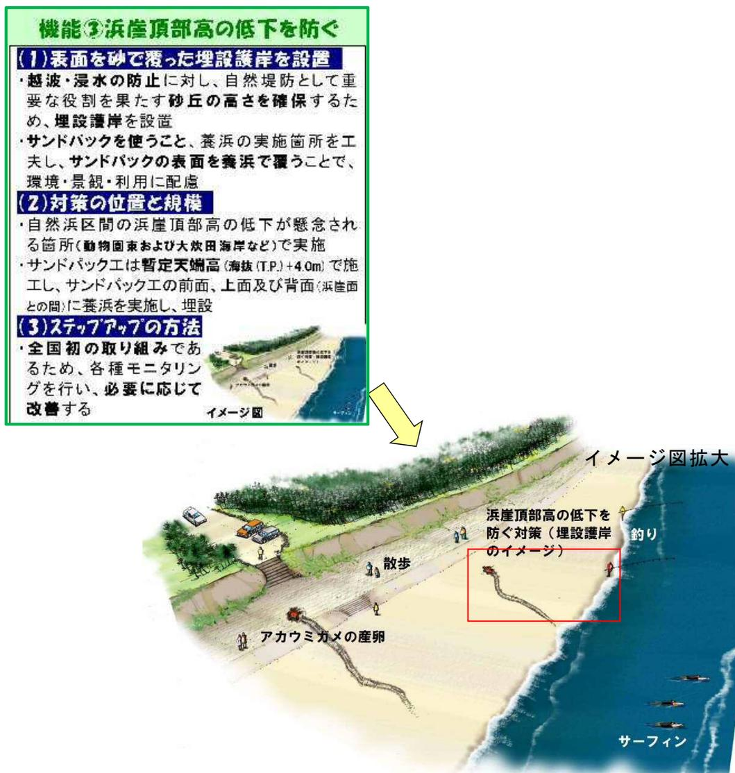
図－2.1 機能③：浜崖頂部高の低下を防ぐ対策の概要
