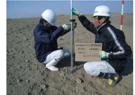
方法②: 深さ1mまでの貫入試験 打撃回数で軟度を評価(下図)
