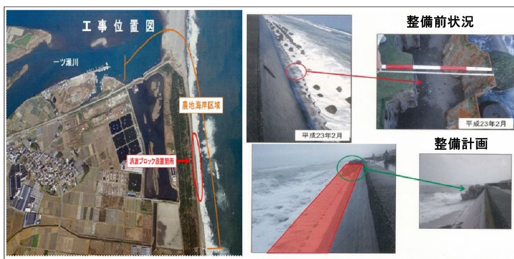
工事位置図および実施箇所状況
