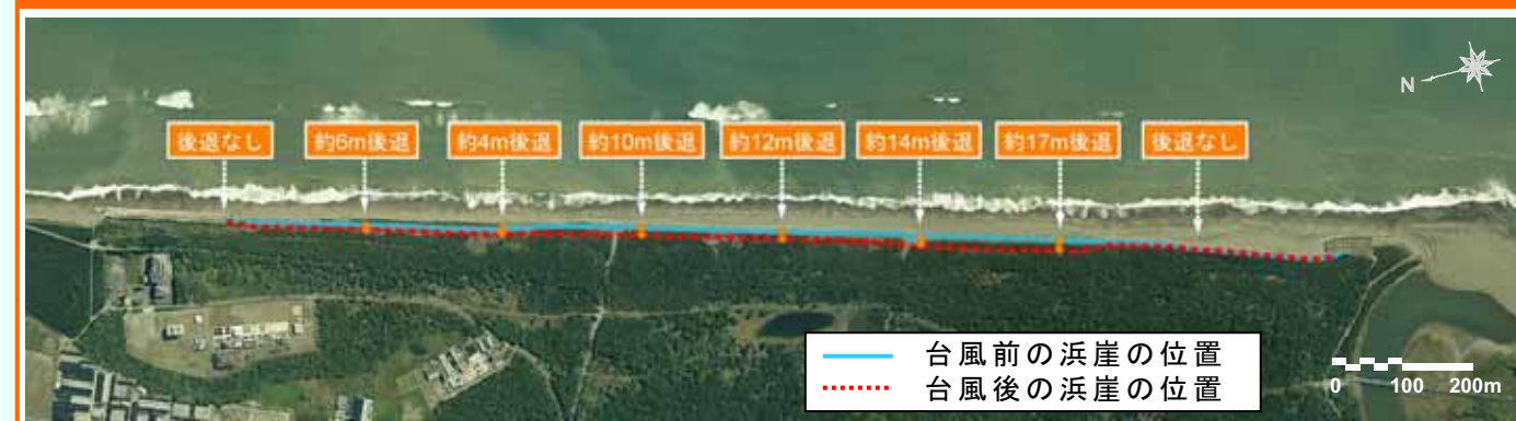
大炊田海岸 平成23年(2011年)【台風6号,12号,15号通過後の浜崖後退】
