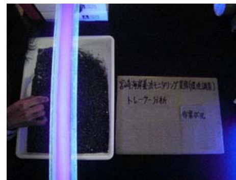
漂砂トレーサー分析状況
