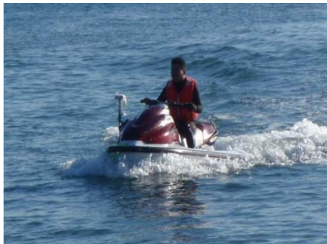
碎波帯域の測量状況
