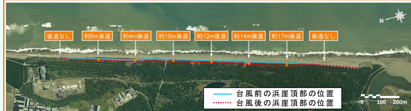
大炊田海岸 平成23年【台風6号,12号,15号通過後の浜崖位置の変化】
