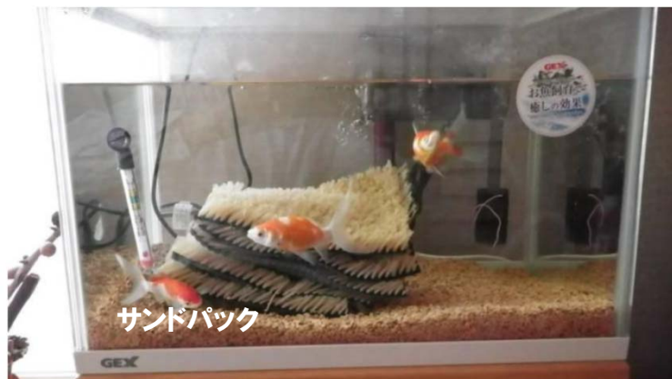
金魚飼育試験 (試験体から有害物質が溶出しないか確認する)
