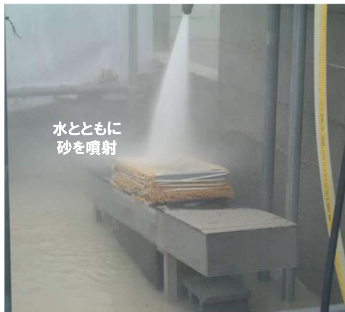
劣化試験 (砂の磨耗に対する劣化状況を確認する)
