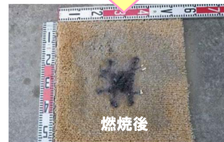
たき火(燃焼)試験 (燃焼が拡大しないかを確認する)
